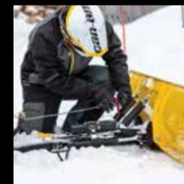
Das Windenseil mit einem Führungshaken/ einer Führungswalze am Schild anbringen.
