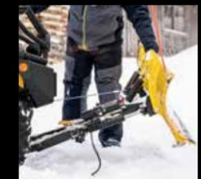
Seilwindenkabel aus der Führung entfernen. Sie sind bereit zum Räumen.
