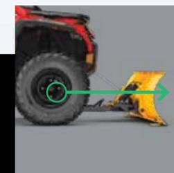
Unterboden-Montageplatten sorgen für den optimalen Schubwinkel und bestmögliche Kraftübertragung beim Schieben.
