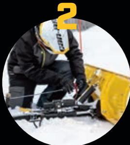
Befestigen Sie das Windenseil mittels Führungshaken/-rolle am Räumschild.
