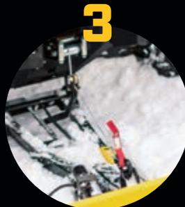
Heben Sie das Räumschild an, bis es an der Montageplatte einrastet.
