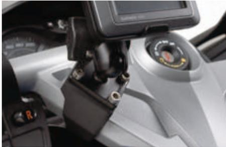
**VERSTELLBARER GPS-GERÄT-HALTERUNGSSATZ (FÜR SERIENLENKER)**
