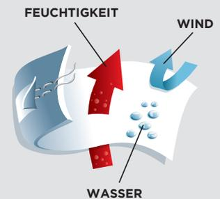
Die Beschichtungen **RPM** und **RPM MAX** halten Wind und Luft draußen, aber lassen die Transpirationsfeuchtigkeit entweichen.
